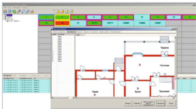
Программный комплекс позволяет использовать систему для обеспечения комплексной безопасности объектов: мониторинга охранной, пожарной, тревожной и технологической сигнализации, интеграции с системами жизнеобеспечения объектов для повышения эффективности их использования.
