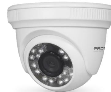
Внутренняя купольная AHD видеокамера нового поколения с разрешением 2.0 Mp (1920×1080 px) на базе уникального сенсора 2.0Mp CMOS 1/2.9" SONY IMX323 и DSP FH8536H. Видеокамера осуществляет обработку 4 типов сигнала: TVI / CVI / AHD 2Mp / CVBS 1000TVL.
