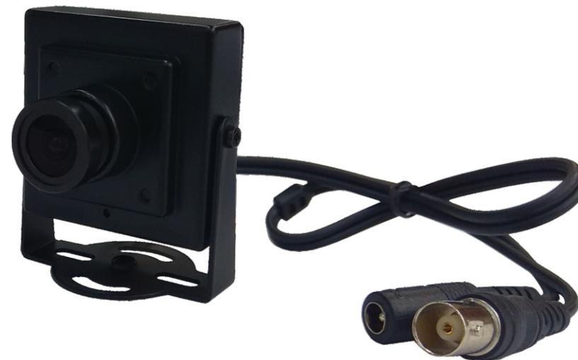
Proto AHD-10Q-EH10F28 – это миниатюрная видеочамера стандарта AHD. В основе камеры процессор DSP HDI8901 и матрица 1/4" H42 CMOS. Камера отлично зарекомендовала себя и способна обеспечить качественное наблюдение там, где поставить камеру большого размера не представляется возможным. Камера выполнена в металлическом корпусе с широкоугольным объективом 2.8 мм, при этом обладает достаточно простой конструкцией, удобной для монтажа.
