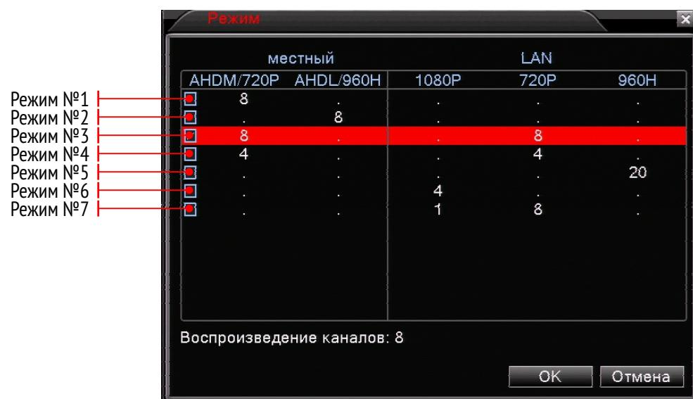
\* Подключение аналоговых камер осуществляется вместо АНД камер, без перезагрузки и только в попарном режиме (одновременно к 1 и 2 входам, либо к 3 и 4 и т.д.)
