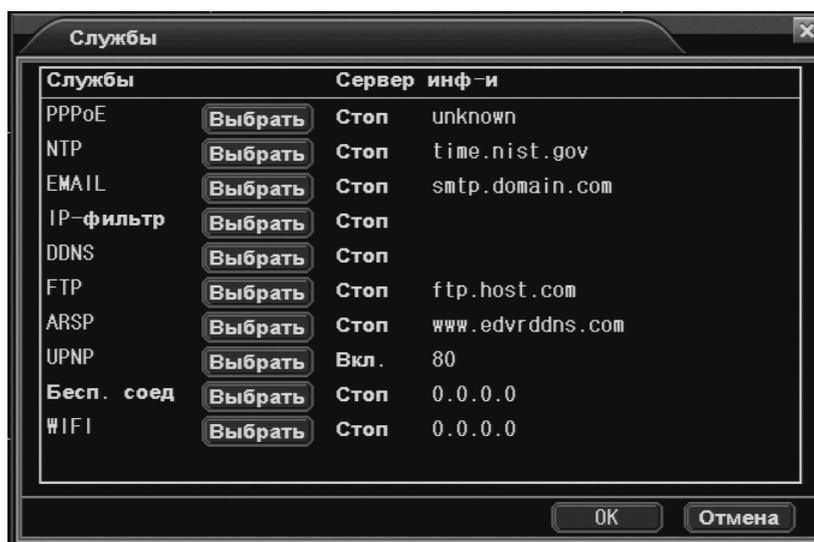
«PPPoE» - настройка подключения через PPPoE. Требуется указать IP-адрес, имя пользователя и пароль (предоставляет ваш провайдер интернет).
