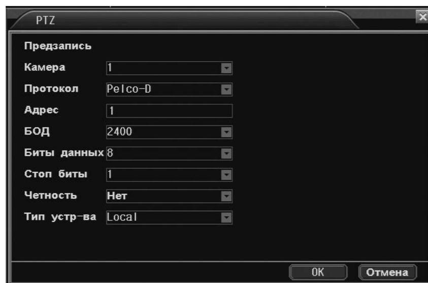
«Камера» - выбор канала, на котором подключена поворотная камера.
