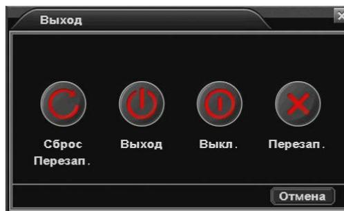
Окно с вариантами завершения работы регистратора: Выключение, Перезагрузка, Выход, Сброс к заводским установкам.
