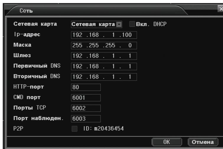
«Сетевая карта» - здесь вы можете выбрать сетевую карту. Функция Вкл. DHCP включает автоматическое получение IP-адреса.
