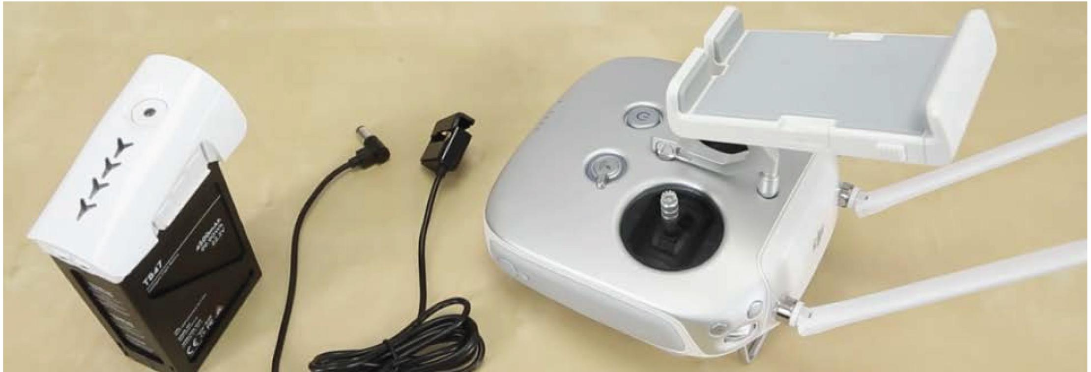
Аккумулятор и пульт управления к зарядному устройству можно подключать одновременно.
