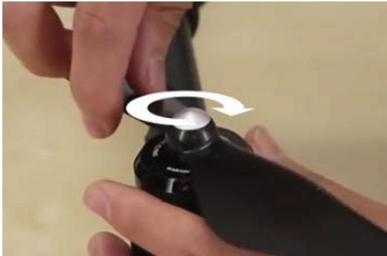
Установите пропеллер отмеченный серебряной меткой на серебряный болт и закрутите по часовой стрелке.
