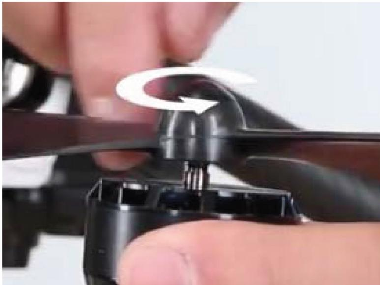
Установите пропеллер отмеченный черной меткой на черный болт и закрутите против часовой стрелки.
