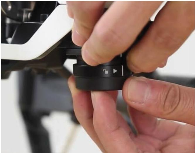
Снимите защитную крышку с места установки подвеса на квадракоптере.
