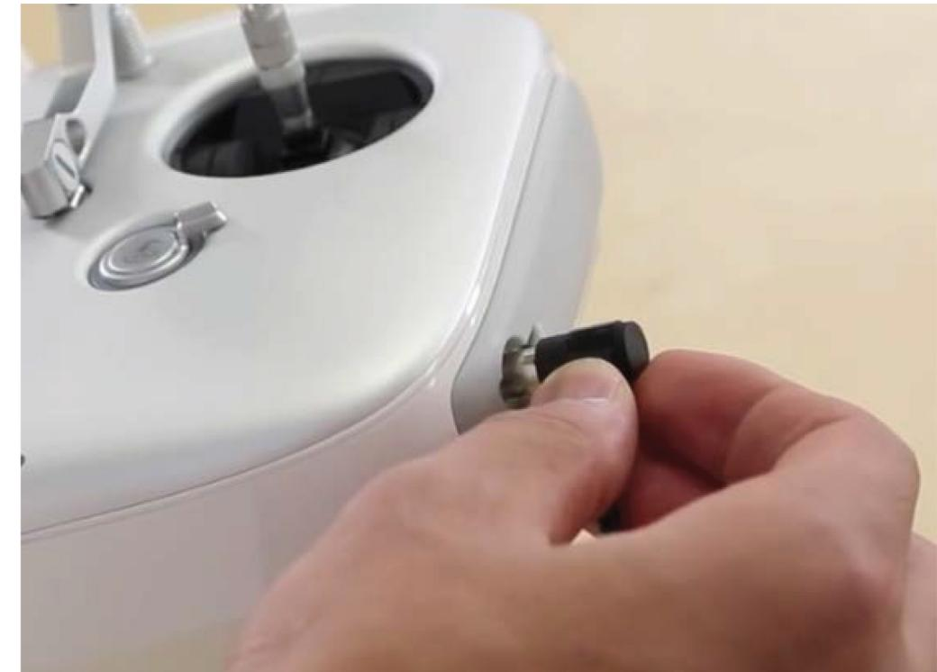
**После подключения зарядного устройства на индикаторах пульта управления и на аккумуляторе отобразится процесс заряда и текущий уровень зарядки устройства.**
