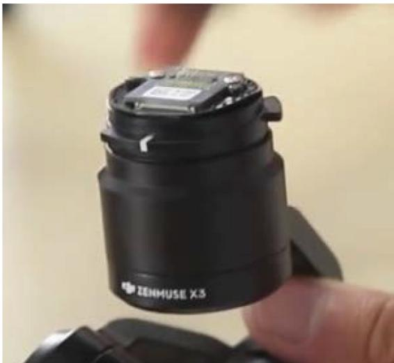
Снимите защитную крышку с подвеса на камере.
