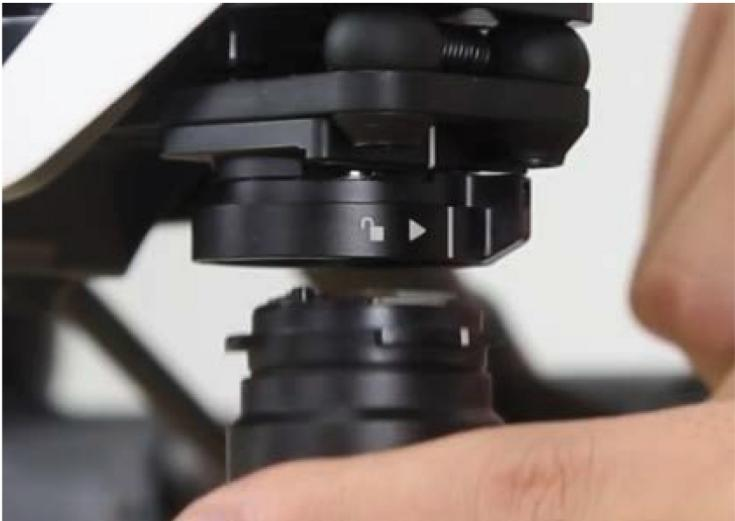
Установите подвес с камерой в квадрокоптер, совмещая белую черту на подвесе с белой чертой на креплении подвеса. После зафиксируйте замок подвеса, повернув его против часовой стрелки.
