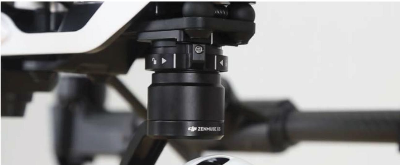
Камера установлена на квадрокоптер и зафиксирована.
